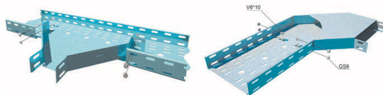
Схемы монтажа аксессуаров для разветвления кабельной трассы
